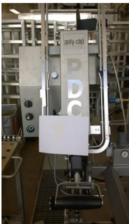
Makkaratekolaite: puoliautomaattinen kaksoissulkijalaite (2013), Polyclipp PDC 700.
