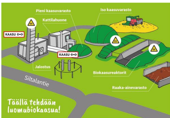
Kuva 1. Palopuron Biokaasu Oy:n biokaasulaitos (Kuva: Nivos Energia Oy).
