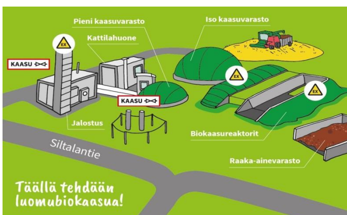
Kuva 4. Palopuron biokaasulaitos. Kuva: Nivos Energia Oy.
