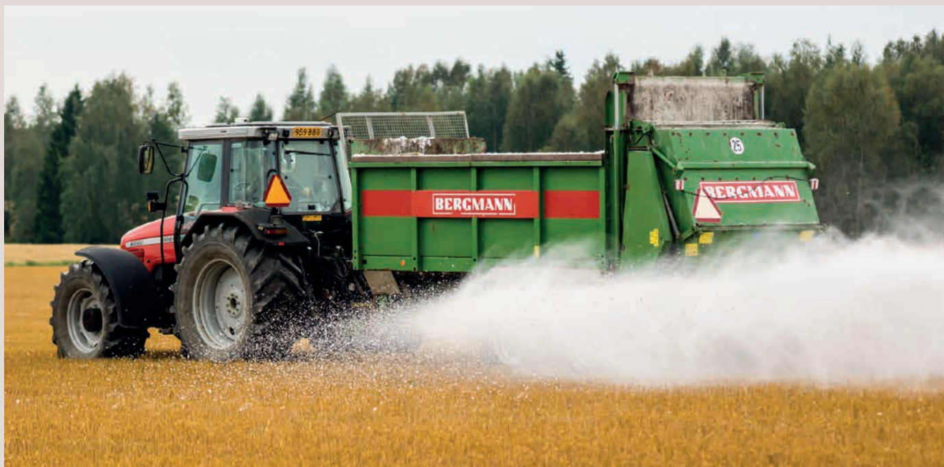
Vid gipsspridningen kan användas en spridarvagn för gödsel (i bilden) eller för fuktig kalk. (Bild: Janne Artell)
